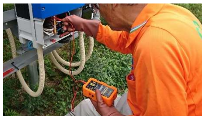
ソラメンテ-Zの直列抵抗(インピーダンス測定)
