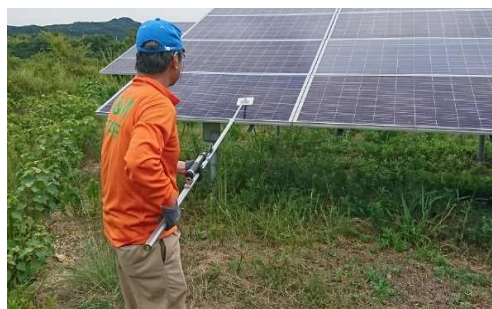
ソラメンテ-iS(SI-200)+連携キット クラスター断線故障パネルを特定する
