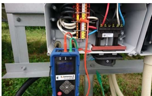
ソラメンテ-Z(SZ-200) ストリングへ故障パネルを探索信号を送信
