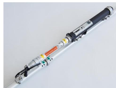
CiSアダプター SC-200 を使用するときには、先ず SC-200 を SI-200 本体ユニットに取付け、次に ⑥ コネクタを SC-200 の本体ユニットと反対側のコネクタに取付けます。SC-200 の使用方法については、SC-200 取扱説明書をご参照ください。
